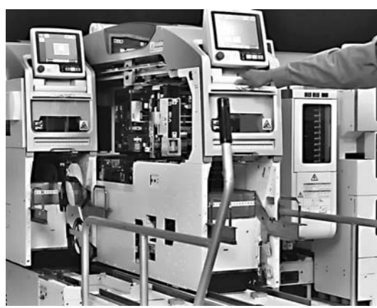
写真1 XYロボットモジュール交換
